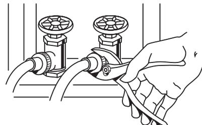
**REMARQUE :** Ne pas serrer excessivement. Le raccord risque d'être endommagé.
