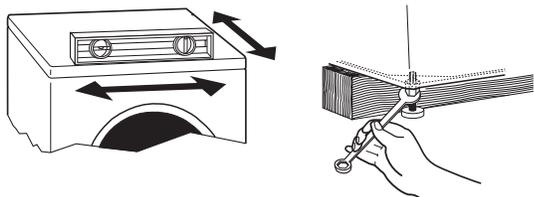
Si la laveuse est placée contre un mur, on doit l'écarter légèrement du mur avant de l'incliner vers l'arrière. Si la laveuse n'est pas d'aplomb, soulever l'avant de la laveuse avec une cale de bois et ajuster la position des pieds au besoin; soulever ensuite l'arrière de la laveuse et ajuster la longueur des pieds au besoin. Répéter ces opérations jusqu'à l'obtention d'un aplomb correct de la laveuse.
