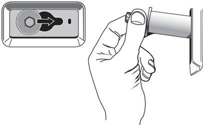
3. Une fois que les 4 boulons de transport ont été retirés, jeter les boulons et les cales d'espacement. Puis tirer le cordon d'alimentation à travers l'ouverture du panneau arrière et obturer le trou avec le bouchon fourni.
