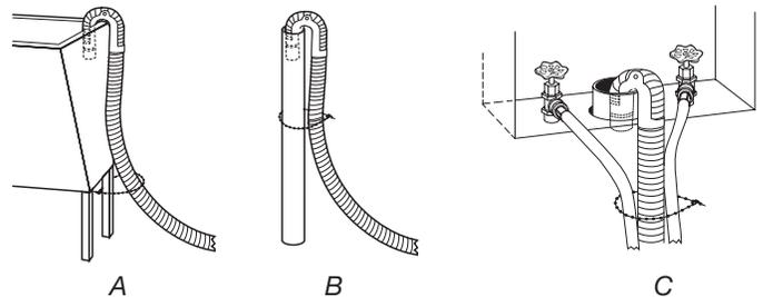
Si les robinets d'eau et le tuyau de rejet à l'égout sont placés en retrait (voir illustration C), introduire l'extrémité en col de cygne du tuyau de vidange dans le tuyau de rejet à l'égout. Attacher fermement les tuyaux d'arrivée d'eau et le tuyau de vidange ensemble, avec la courroie perlée.
